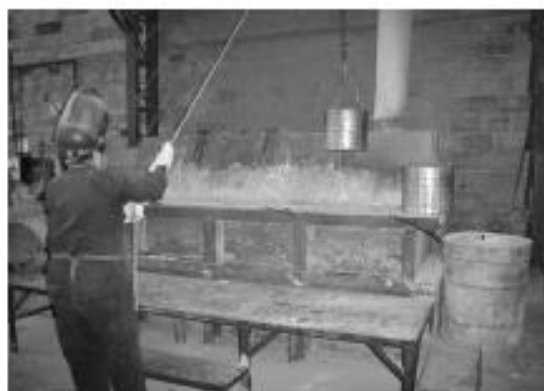
Figura 2. Proceso de inmersión en baños de lavado de las piezas. Empresa N° 1.
