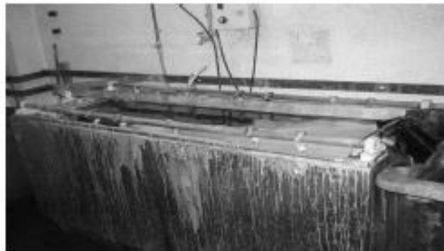
Figura 4. Proceso de inmersión en baños de lavado, compuestos altamente corrosivos. Empresa N° 3.
